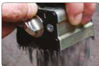
Po vypnutí zemního magnetu PowerBase™ odpadnou kovové nečistoty.
