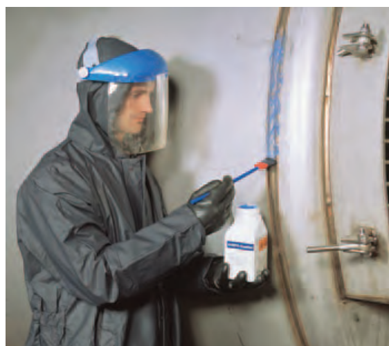
Avesta BlueOne™ Pickling Paste 130 – nanášení štětcem, nejlepší použitelná technika
